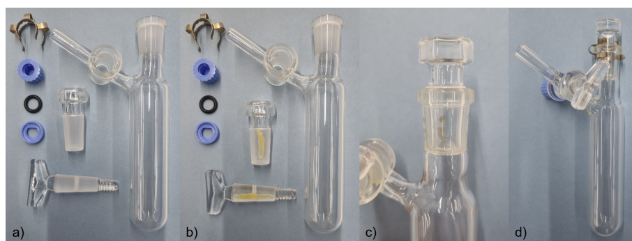
Figure 2 Graissage et insertion d'un robinet en verre rodé et d'un bouchon dans un flacon de Schlenk. Une graisse à base d'hydrocarbure est utilisée par souci de clarté.
